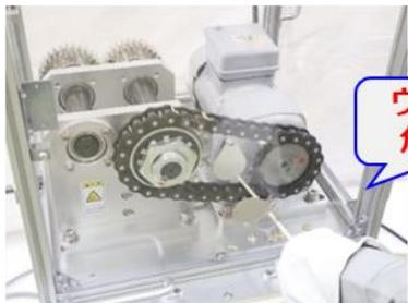
動作中のギアやベルトにはさまれ、巻き込まれた時の機械の力強さ、衝撃を体感します。
