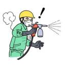
化学工場内における廃棄物焼却炉の定期補修工事で、耐火物へ耐火物の硬化時間促進剤である急結剤の吹付け作業を行っていた。その際、<u>ノズルとホースの接続部から飛散した強アルカリの急結剤</u>が作業者3名の皮膚に付着したことにより、3名とも薬傷(化学性皮膚炎)を負った。
